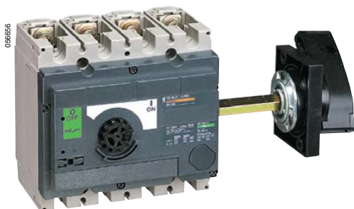
Выключатель Interpact INS250 с боковой выносной поворотной рукояткой
