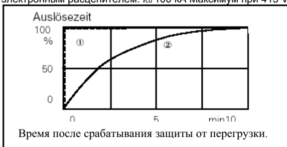
Рис. 125: Время восстановления расцепителя после срабатывания защиты от перегрузки 1 „без термической памяти“ 2 „с термической памятью“
